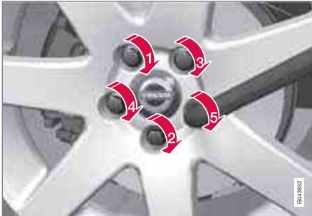
Tighten the lug nuts
