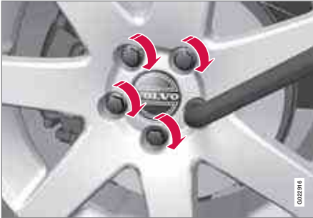
Tighten the lug nuts
