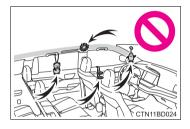
Véhicules dépourvus de système d'accès et de démarrage "mains libres": N'attachez pas à la clé d'objets lourds, pointus ou très durs, comme d'autres clés et accessoires. Ces objets risquent d'entraver le déploiement du coussin gonflable de genoux SRS du conducteur ou d'être projetés vers le siège conducteur par la force de déploiement du coussin gonflable, entraînant ainsi un danger.
