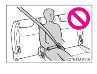
N'utilisez pas la ceinture de sécurité du siège central de la troisième rangée avec l'une ou l'autre des boucles déverrouillées. Si une seule des boucles est verrouillée, ceci peut entraîner des blessures graves, voire mortelles en cas de freinage brusque ou de collision.
