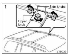
ADJUSTING THE POSITION OF CROSS RAILS:
