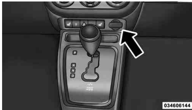
12 Volt Power Outlet
