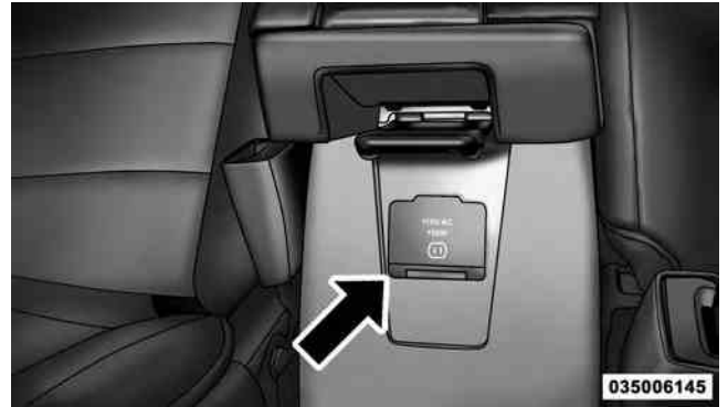
115 Volt Power Outlet
