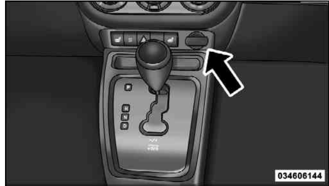
12 Volt Power Outlet
