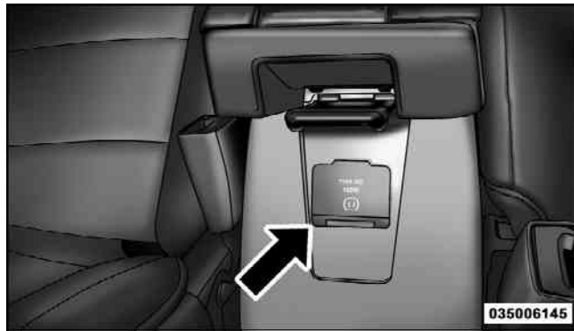
115 Volt Power Outlet
