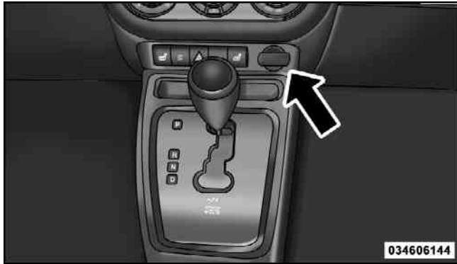
12 Volt Power Outlet
