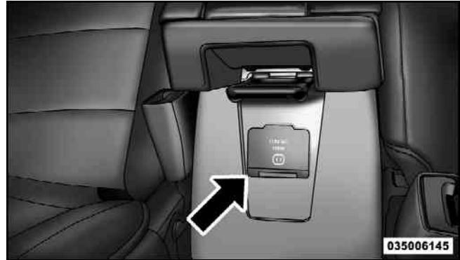
115-Volt Power Outlet
