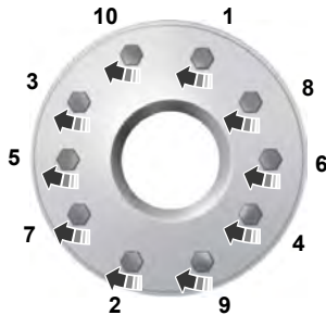
10-lug nut torque sequence
