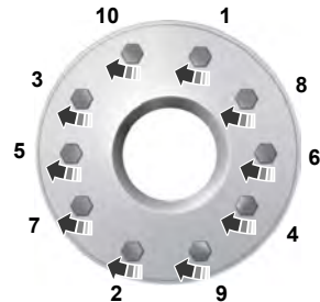
10-lug nut torque sequence
