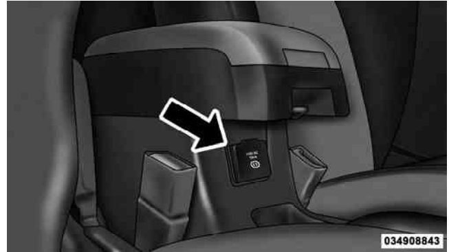
115 Volt Power Outlet
