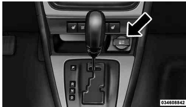
12 Volt Power Outlet
