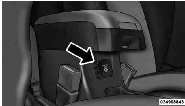
115 Volt Power Outlet
