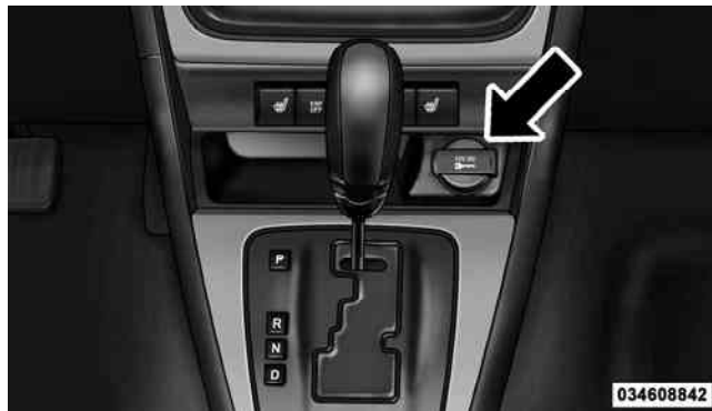
12 Volt Power Outlet
