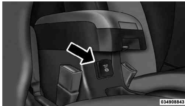
115 Volt Power Outlet
